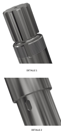
EJE 27,2 CM Acero 4140, acero de alto carbono con temple y revenido (aprox 30 RC)
